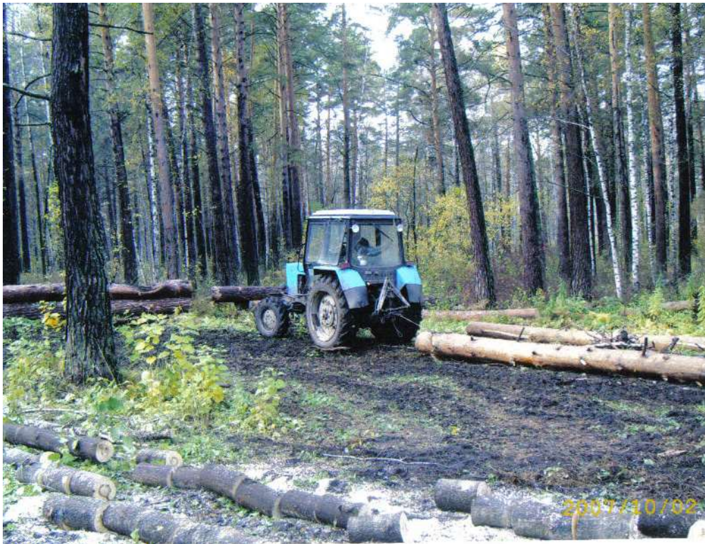
Рис. 22 Сельскохозяйственный трактор МТЗ 82-1 в процессе трелевки сортиментов на погрузочном пункте
